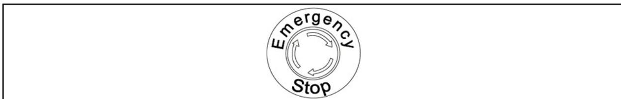
Im Falle einer Gefahrensituation bringt er die Maschine sofort in einen sicheren Zustand. Nach dem Betätigen des Notausschalters muss der Schalter wieder entriegelt und der sichere Zustand der Maschine durch Drücken einer Taste bestätigt werden.
